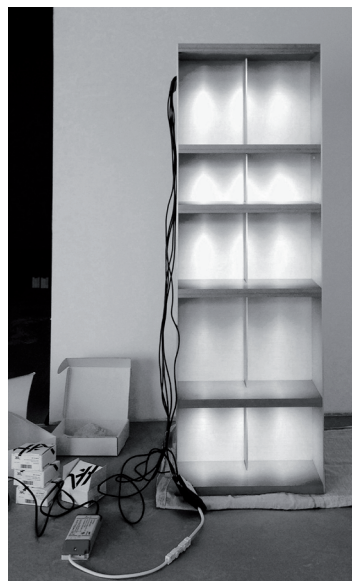
Aluminiumvitrine / Verkabelung / Converter / Dali Dim Control
